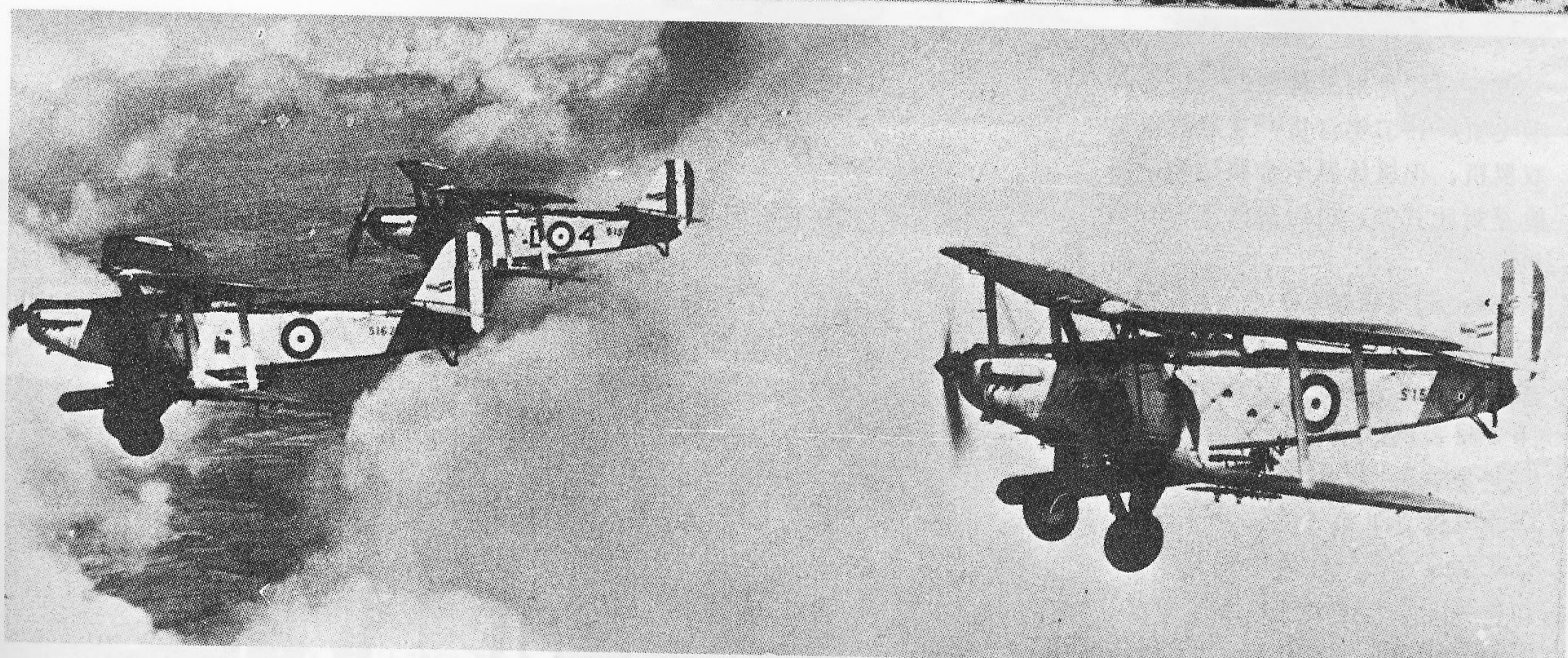
“里彭” Blackburn Ripon 英国海军第一种双座鱼雷轰炸机，1929年至1934年服役，比布莱克本·标枪式作战半径大一倍。该机翼展13.9米，长11.2米，高3.91米，最大起飞重量3359公斤，时速191公里，装1挺机枪，可挂一条鱼雷，或6颗104.3公斤炸弹或3颗236公斤炸弹。图为3架里彭式编队飞行时的情景，机腹下的鱼雷清晰可见。
