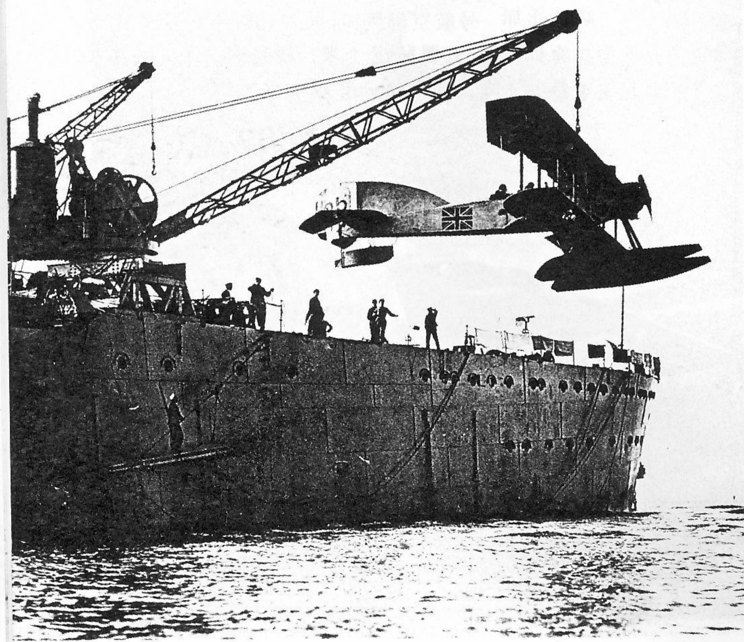
英国是最早发展航空母舰的国家，早在1911年12月，萨莫森海军上尉便驾驶一架S—27式双翼机，完成了英国人从军舰上的第一次起飞。尔后，英国皇家海军即着手探索建造搭载飞机的军舰。1913年5月，便将“竞技神”号船巡洋舰改装完毕，撤掉首尾主炮，各装一个停机平台。但是，英国人建造的第一艘真正的水上飞机母舰，是用运煤船改建的“皇家方舟”号。上图为1918年12月拍摄的“皇家方舟”号。它长112米，宽15.3米，吃水5.3米，排水量7450吨，主机为往复式蒸汽机，输出功率3000马力，航速10.6节，装4座10磅炮和两挺机枪，可载10架肖特式水上飞机。左图为1916年1月16日在地中海水域作战时起吊肖特式的情景。水上飞机只有在水面才能起飞和降落，此时，母舰必须停下来，把它们吊放水面和吊到舰上。该舰1914年服役，不久即参加了在地中海的作战，1934年改名为“柏伽索斯”号水上飞机母舰。
