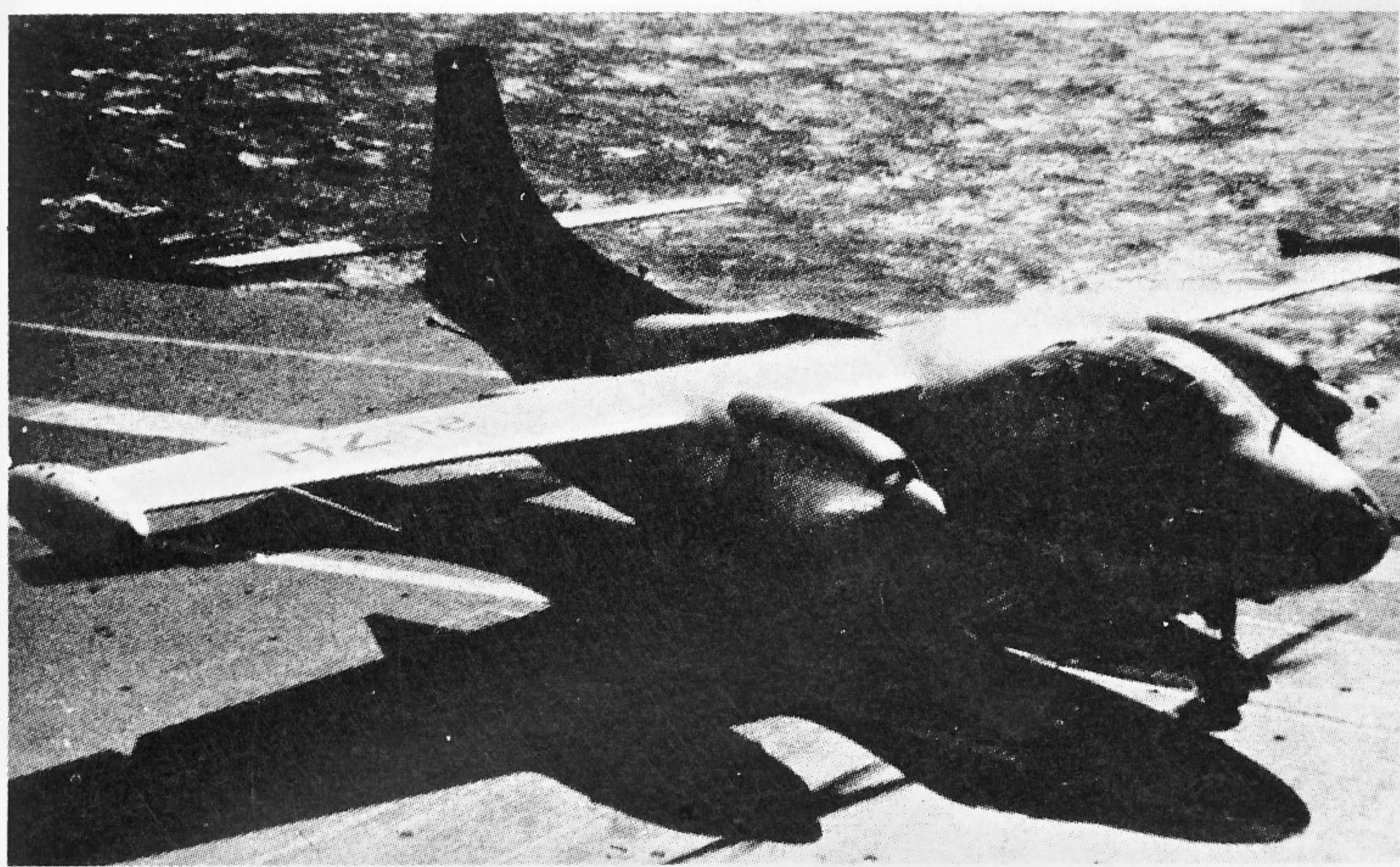
上：AJ-2 Savage “野人” 北美航空公司1946年设计。装两台活塞式发动机，输出功率各为2300马力，后部一台喷气发动机，推力2.1吨，1949年服役，共造143架。照片为作侦察机或加油机使用时所摄。翼展21.8米，机长19.5米，最大起飞重量24.3吨，时速713公里，挂弹5.4吨，乘员3名。
