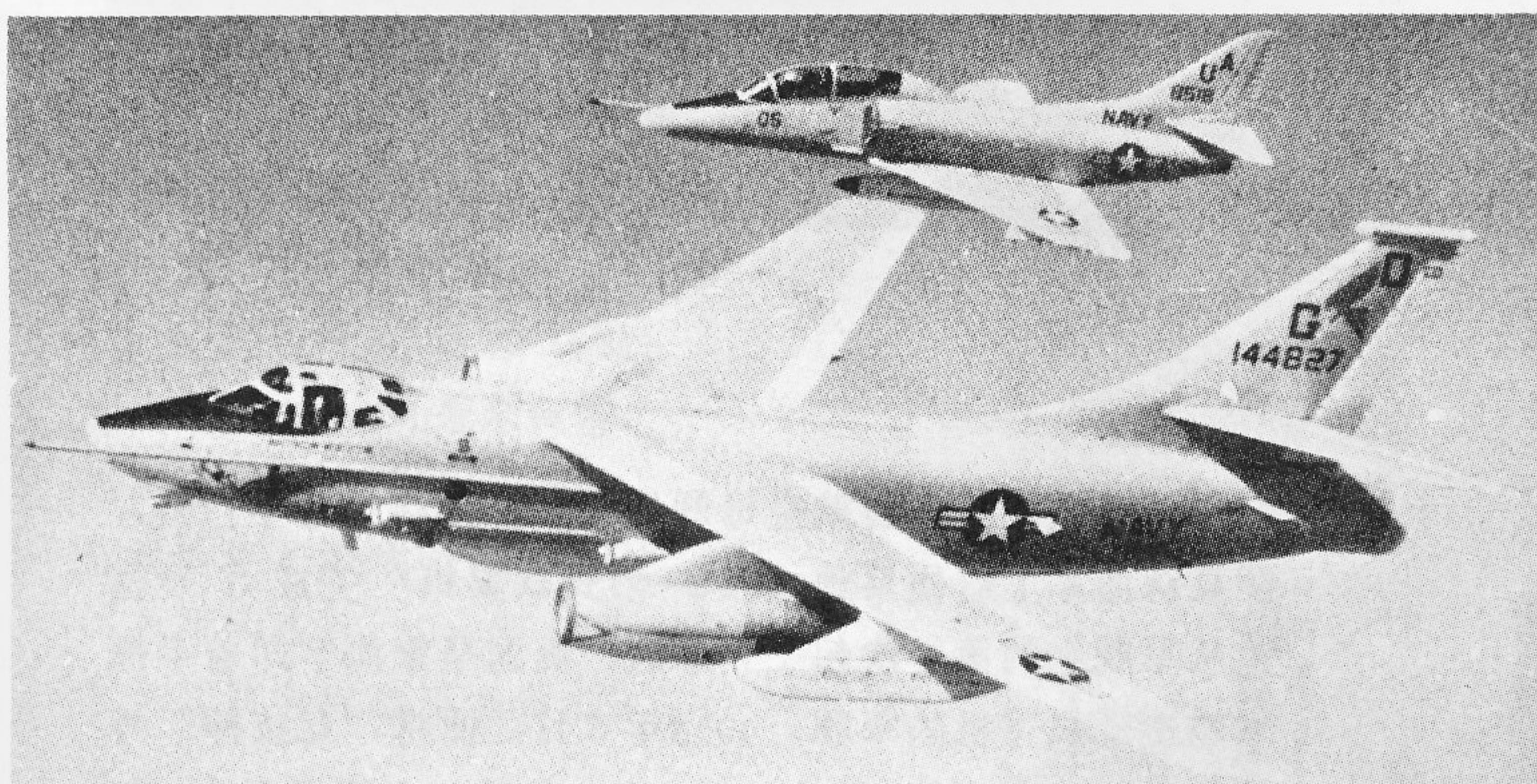
中上：A3D Skywarrior “空中战士” 道格拉斯公司生产的高速双发喷气机。主要性能数据为：翼展22.1米，机长22.7米，最大起飞重量35.1吨，推力9.4吨，速度M0.88，挂弹5.8吨，乘员3名。编队中后面的为A-4攻击机。该型机一直使用到70年代后期。
