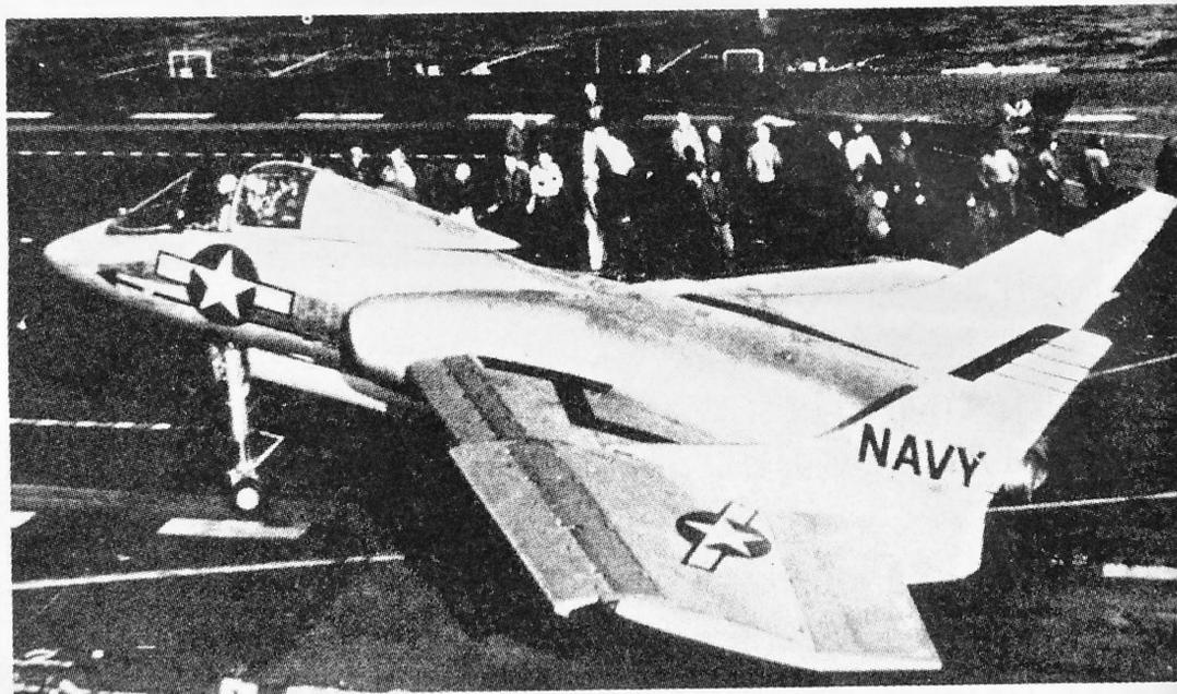
▷F7U-3 Cutlass“弯刀” 沃特公司生产的喷气式舰载战斗机，1948年试飞，1955年美国海军装备305架，由于使用状况不佳，于1957年退出第一线。主要性能数据为：翼展11.8米，机长12.4米，最大起飞重量9.1吨，时速1120公里，装4座20毫米炮。
