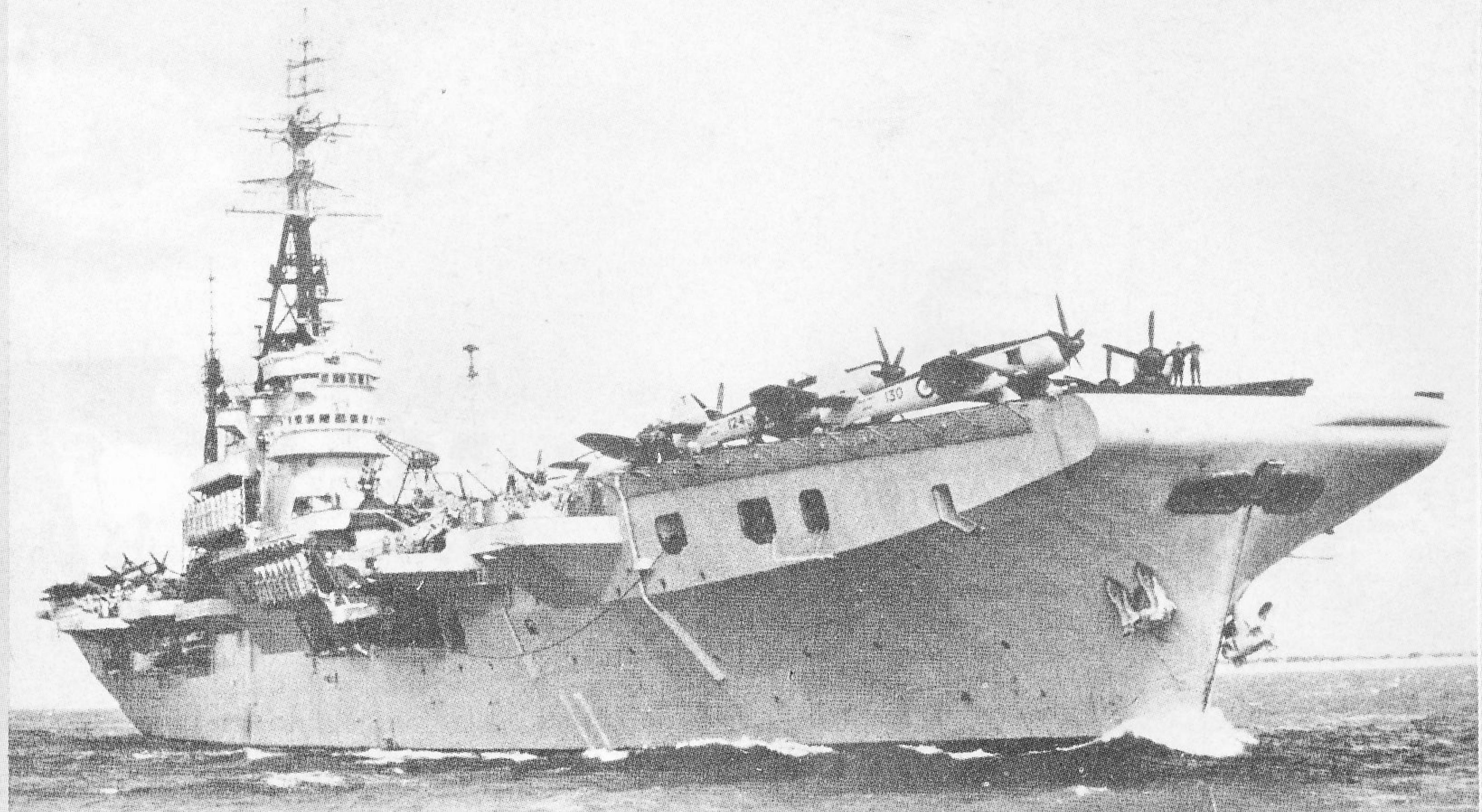
“凯旋”号于1946年4月竣工，服役后用于训练和一系列试验，1949年被派往远东，随后参加了侵朝战争，主要负责运送部队。1952年2月，曾在该舰飞行甲板上划了一个斜角甲板降落区，并拆除了左舷的一些障碍物，以试验飞机尾钩没有钩住拦阻索时拉起复飞的可靠性。1958年至1965年期间，又利用其大机库（长135.6米，宽15.8米，高5.3米）将之改造成了一艘大型修理舰。照片为轻型航空母舰时所摄。
