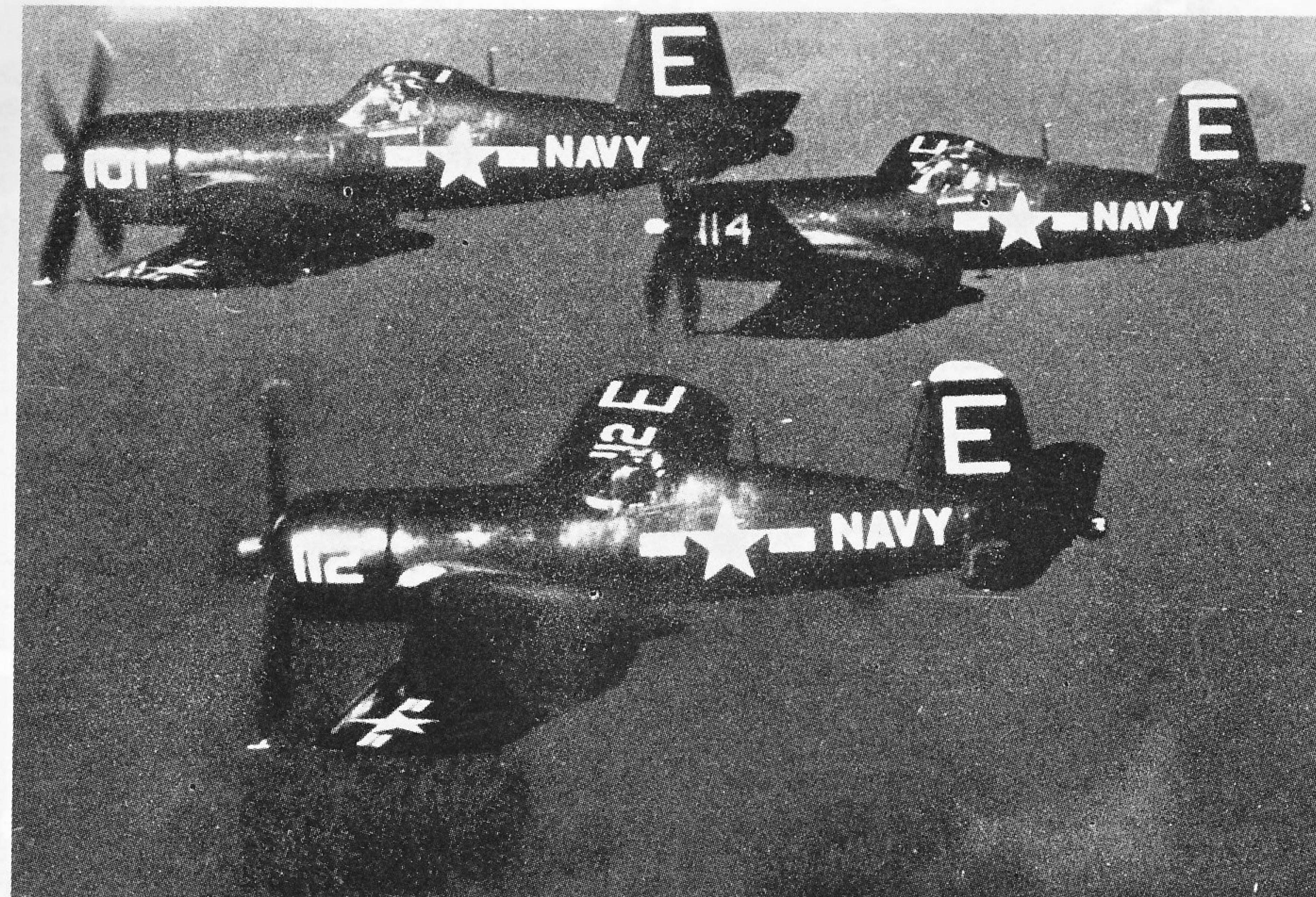
F8F-1 Bearcat “熊猫”由格鲁曼公司制造，作为装活塞发动机的螺旋桨飞机来说，F8F 具有许多优良性能，但作战距离短，加之服役时恰逢喷气机问世，所以不久便退出一线，用于训练。照片摄于1949年6月。主要性能数据为：翼展10.8米，机长8.4米，最大起飞重量5.8吨，输出功率2400马力，时速686公里，装4挺12.7毫米机枪，共生产1263架。
