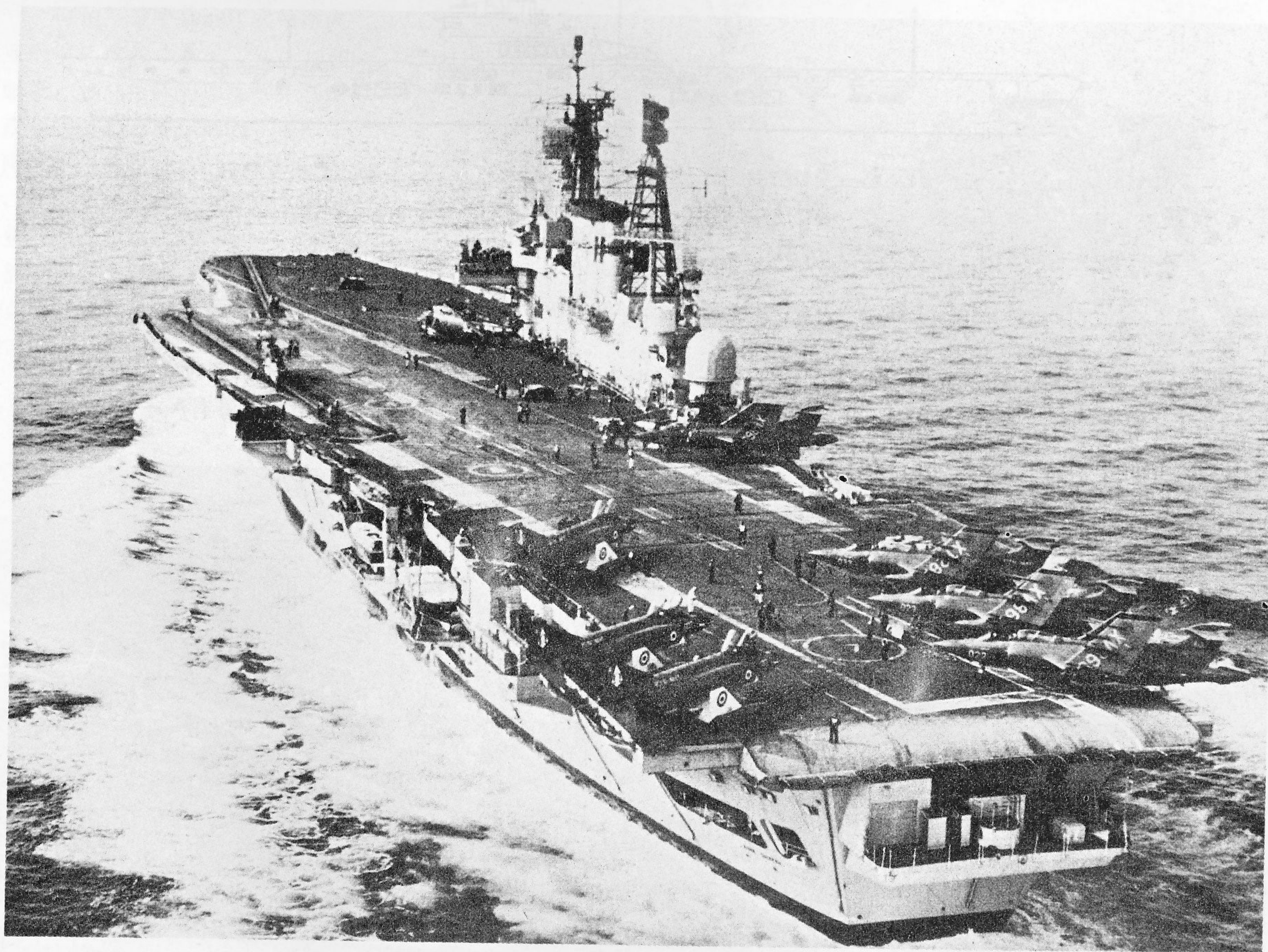
1978年11月在地中海上航行时的情景。1959年改装时，在主桅前后装了 965型对空警戒雷达。1969年末，又撤除了尾部两舷的114毫米炮和机关炮，扩大了飞行甲板，同时装了 4座海猫舰空导弹发射装置。停在飞行甲板上的，为鬼怪式战斗机和海盗式攻击机。
