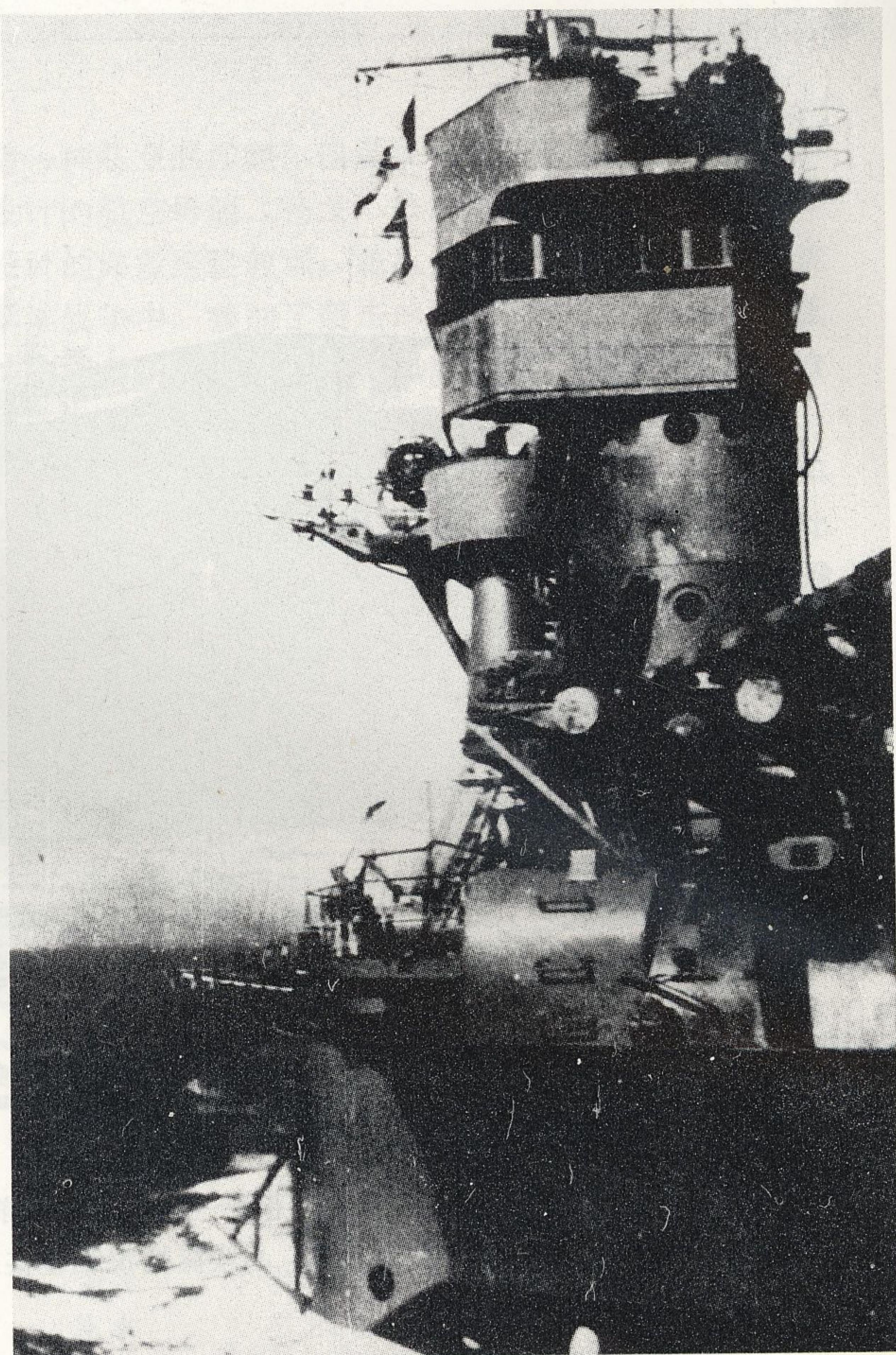
1937年11月在丰后水道试航时拍摄的“苍龙”号右舷舰桥。和英、美航空母舰相比，日本航空母舰的岛式上层建筑较小，烟囱大多设在飞行甲板之下。舰桥上方设防空指挥所，60厘米信号灯，1.5米测距仪和环形辨向天线等。正面炮座上为3号双联127毫米高射炮。
