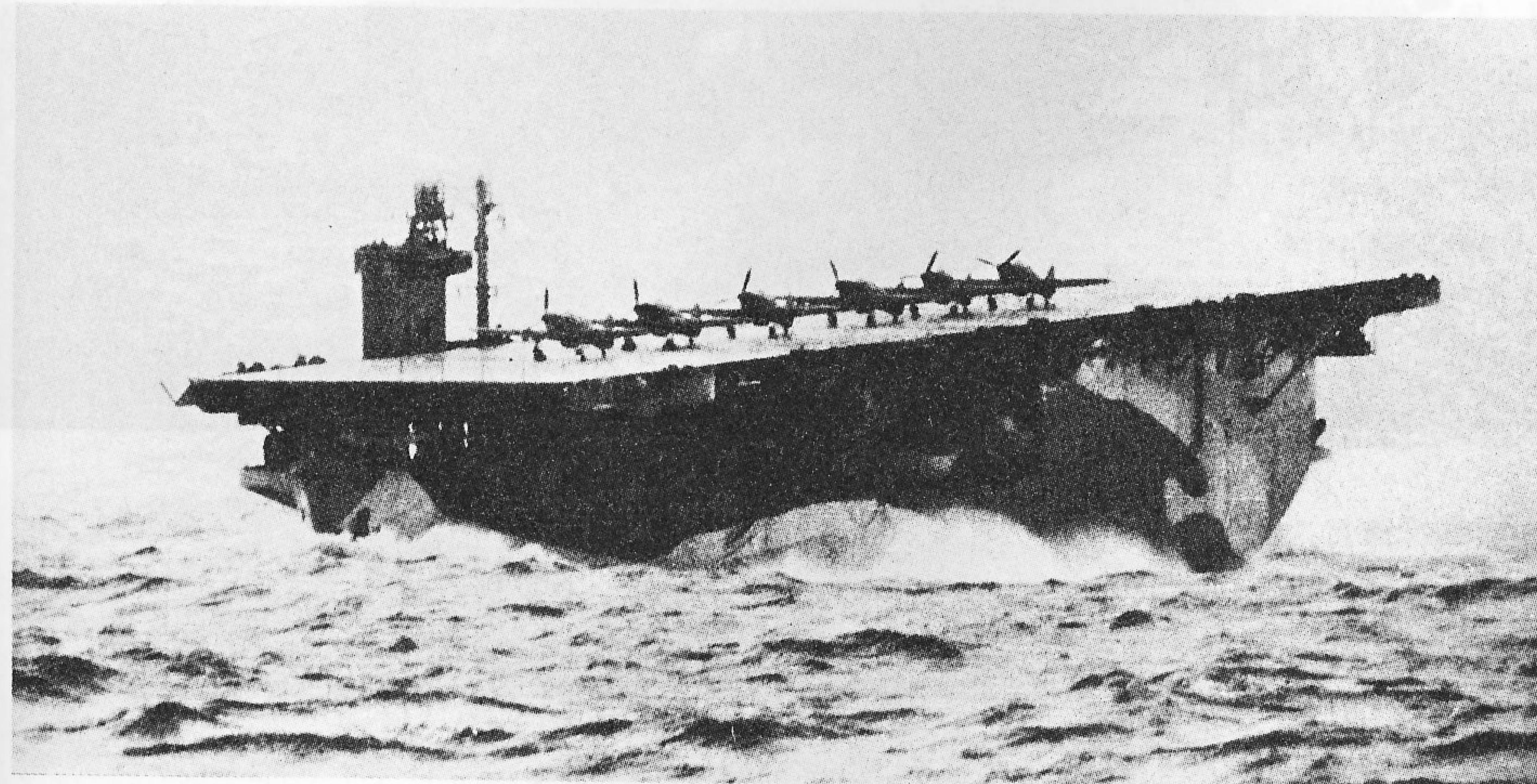
用作训练舰。标准排水量8200吨（9000吨 \*），长150米，宽20.2米，吃水7.1米，柴油机，8500马力（9000马力 \*），航速16.5节（17节 \*），装1座127毫米炮，两座76毫米炮，10—11座20毫米炮，载机15架，舰员555名。上图为“射手”号，左图为“欺骗者”号。“复仇者”号于1942年战沉，“冲击者”号于1943年战沉，“射手”号和“欺骗者”号于战后送还美国。
