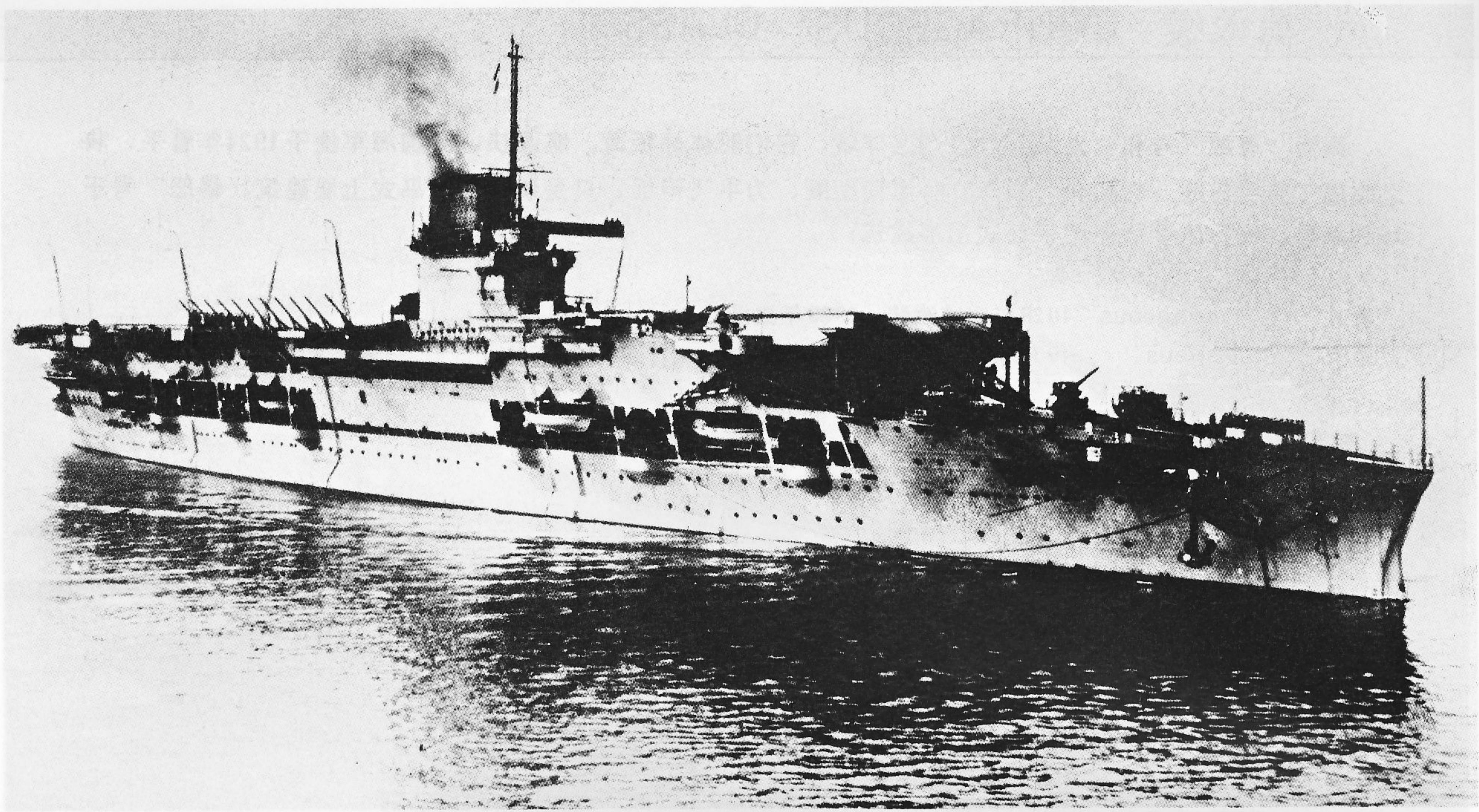
“光荣”号于1930年完成改装后，又于1934年至1935年进行了现代化改装。改装的重点是：在首部飞行甲板两舷和岛式上层建筑前后分别加装了乒乓炮。在首部飞行甲板两侧，则加装了弹射器。
