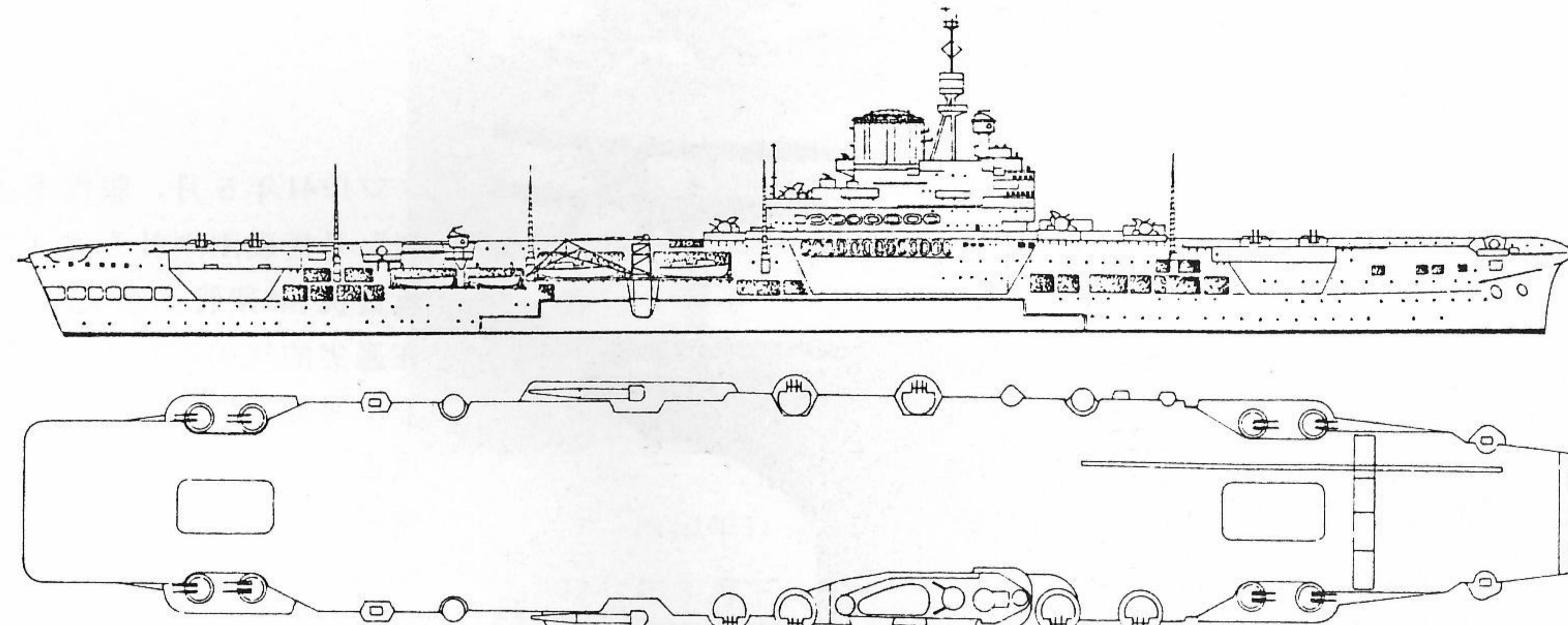
为英国皇家海军的第一艘装甲甲板航空母舰，舷侧装甲114毫米，顶部装甲为76毫米，同时还装有第一批制造的79Z型对空警戒雷达。1940年11月11日晚，它曾出动21架箭鱼式鱼雷机空袭了意大利塔兰托港，击沉了3艘意大利战列舰。战果之巨，甚至超过了英国主力舰队在日德兰海海战中所取得的战果。照片摄于1947年3月，这时，“光辉”号有些装备已作了更新，和刚服役时有所不同。
