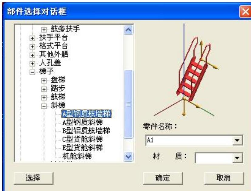
然后通过部件类别下拉框和参数化部件下拉框选择要安装的铁舢件。也可以通过点击选择按钮在图形平面中选择和要安装的铁舢件同类别的部件
