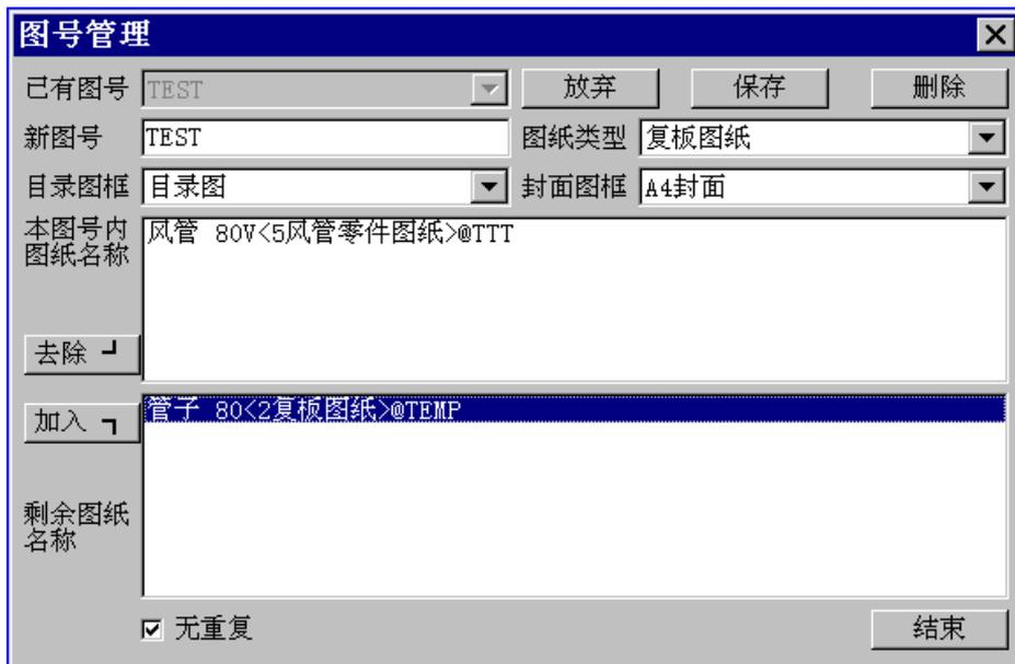
要修改图纸，则先从“已有图号”中选择要修改的图号，然后按“修改/放弃”按钮，该图号的数据显示在对话框中，然后进行图纸添加和去除、封面和目录设置的修改，最后按“保存/创建”按钮。
