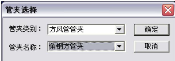
部件选择中选择管夹类别，在图上选择要安装管夹的管子和支架来进行管夹安装。
