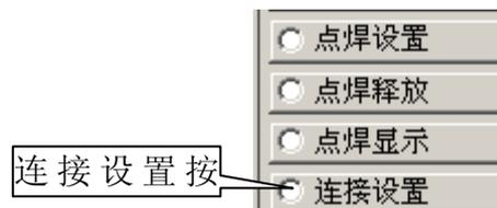
**说明：**连接设置是建立风管、附件之间的连接关系（模型号相互指向）。
