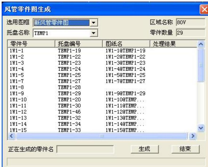
框名称（虽然一般只有一种零件图框，但也可以有多种零件图框，必须每张图纸只能绘制一个零件图）以及托盘名称（或者选择“全部”），则所选托盘中的所有零件都显示在列表中，并且还显示了该托盘的区域名称（当托盘名称选择“全部”时不显示）和托盘中的零件数量，然后选择要生成零件图的零件名（可以选择多个零件），设置零件图的视图方向、节点坐标类别和视图个数以及是否绘制坐标轴线等，最后按“生成”按钮，则自动生成这些零件的零件图，完成后将生成的图纸名和处理结果（成功或者失败及其原因）显示出来。零件图纸的图纸名称按照格式“{零件名称}@{托盘编号}”的格式生成，因此根据零件图的图纸名称就可以知道其它是什么零件了。另外，零件图删除请在工程和模型管理的图纸
