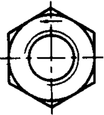
图 5 左旋螺纹的标志
