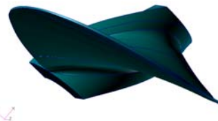
图 5 螺旋桨桨叶几何结构（俯视图）
