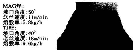
图1 TIME 焊和 MAG 焊角焊缝焊接效率比较
