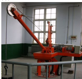
图 1 基于 PLC 船用电动起货机
