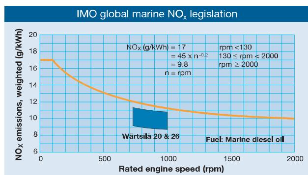
瓦锡兰关注于产品的环保性能。瓦锡兰Auxpac发电机组完全符合IMO MARPOL Annex VI 和 E1APP所规定的环保要求。
