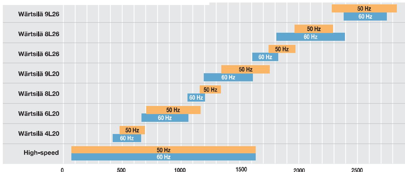
瓦锡兰 Auxpac 中速和高速发电机覆盖了从60到2850 kW<sub>e</sub> 的功率范围。
