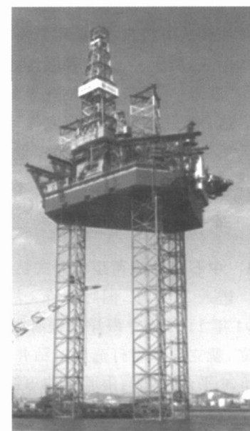
图 9 “海洋石油 941”自升式钻井平台
