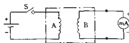
图 1.1.26 用冲击法测定同名端
