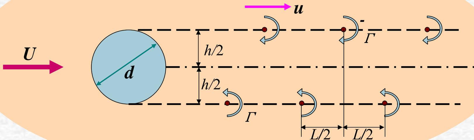
从柱体上、下面分别脱落的旋涡，其旋转方向是彼此相反的，同时所有旋涡都以相同速度（因有旋涡间相互干扰，此速度比来流速度小）向下游移动。
