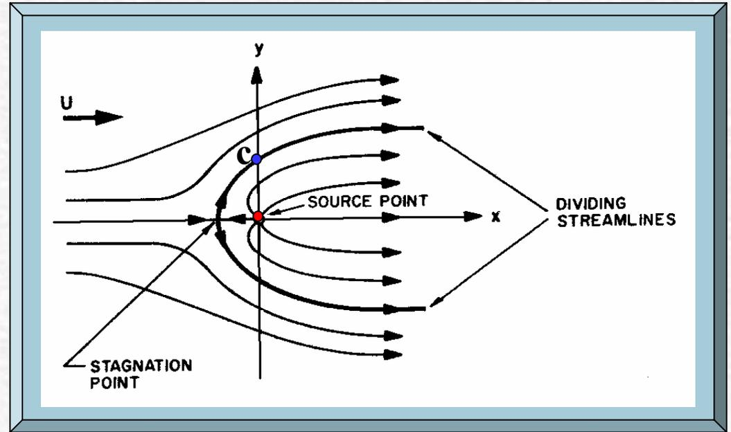
过驻点流线在下游无穷远处开口宽度
