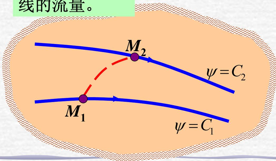
画出穿过微元弧长的流量示意图，可以帮助记忆流函数定义。
