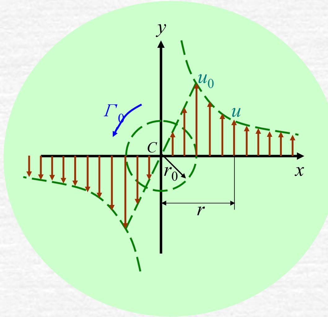
兰肯涡是比较接近实际的平面旋涡模型，其中心部分的流体象刚体一样旋转，需有外力不断推动，中心部分也可用圆柱形刚体的转动来代替。外围部分流体的运动在开始时是由中心部分的转动通过粘性的作用形成的，在流动稳定以后，则无须再加入能量，粘性也就不再起作用。
