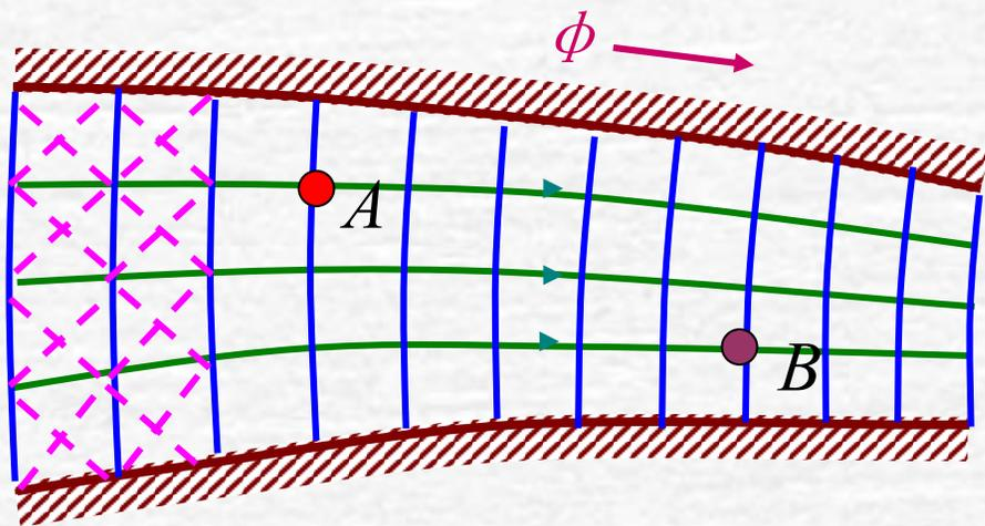
流网密处, 流速大、压强小。流网疏处, 流速小、压强大。已知一点处流速、压强, 可知各点流速和压强。
