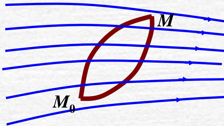
根据定义确定流函数时选取不同的起点  $M_0$ ，流函数将相差一个常数，但同样不会影响对流场的描述。
