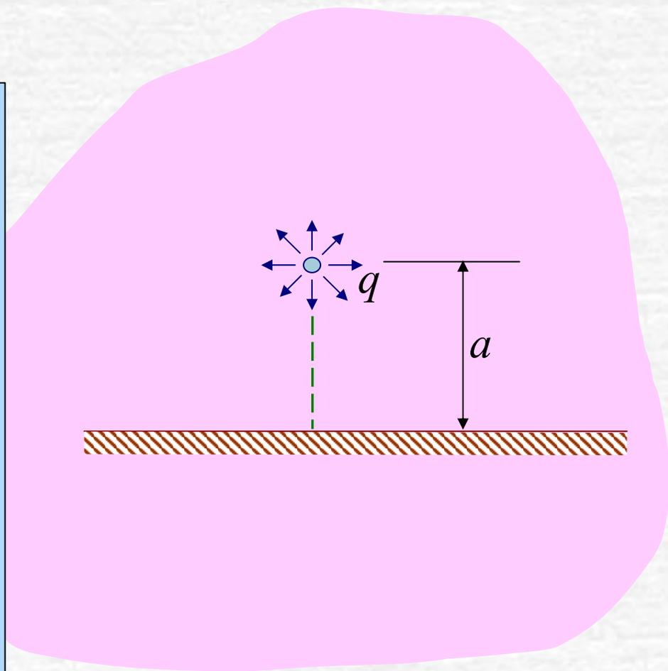
不妨以上半平面流体区域放置孤立奇点为例，探讨固壁  $x$  轴对流动的影响。按照流线与固壁的等价原理，将流场延拓到下半平面，并在下半平面与原奇点关于  $x$  轴对称的位置放置同样的奇点，使延拓后的全平面流场中  $x$  轴成为一条流线，这样新加的奇点对原奇点的影响就取代了固壁  $x$  轴的作用。
