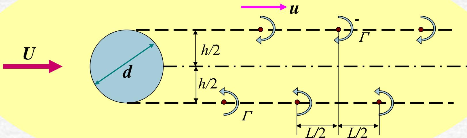
旋涡从圆柱体上交替地脱落到下游，因而形成周期性的振动，旋涡从柱体上脱落的频率  $f$  将以斯特劳哈尔数表达，并由雷诺数决定
