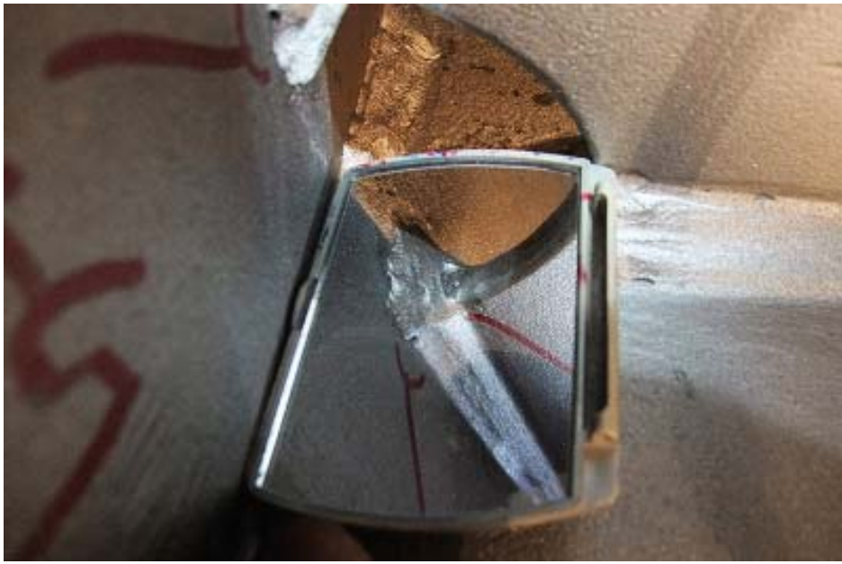
11: 复板下边口焊缝差 (---结构报检阶段清除)
