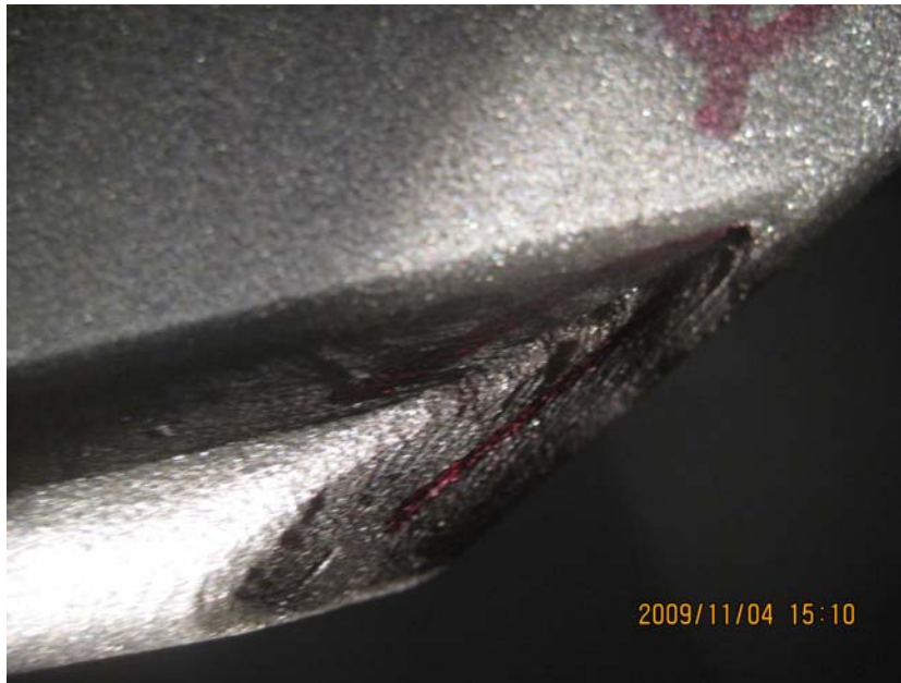
15: 削尖的球扁钢端头或是加强板端头 R2 差 (---结构报检阶段清除)
