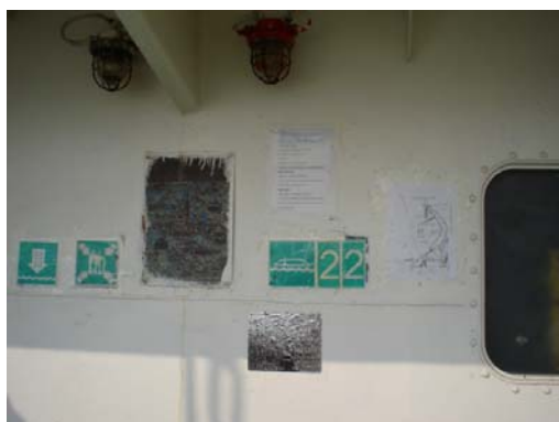
(粘胶纸粘贴, 极易脱落)
