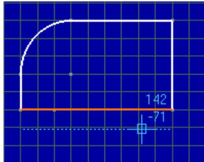
相切方式偏置(Tangent Propagation):
