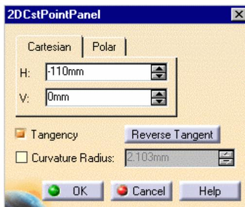
可重新输入坐标值，对控制点进行编辑。
