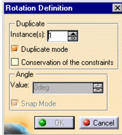
检查复制模式(Duplicate mode)状态，选中为复制， Instances(s)后可输入复制数目。不选中则为旋转移动。若选中保持约束(Conservation of the constraints)模式，则复制后元素保持原有约束。
