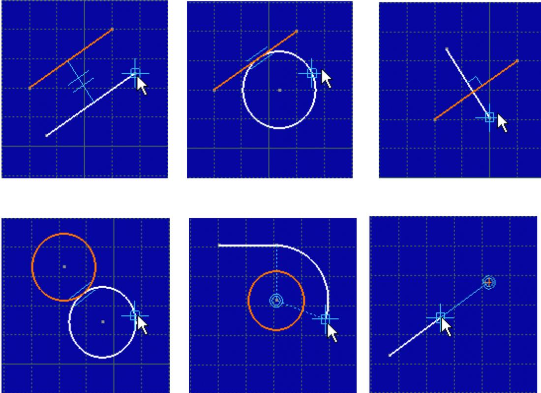
由于智能捕捉会产生多种可能的捕捉方式，因此设计者可以使用鼠标右键弹出下拉菜单进行选择或按住Ctrl键对所捕捉方式予以固定也可按住Shift键放弃任何捕捉方式。
