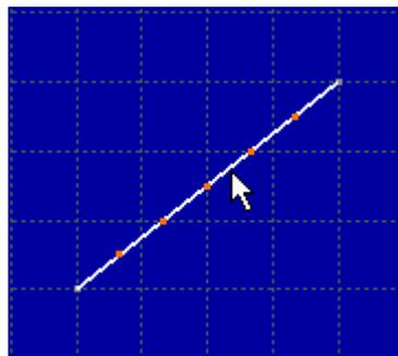
在新创建点数目 (New Points) 栏输入希望创建的点的数量, 得到等距点。
