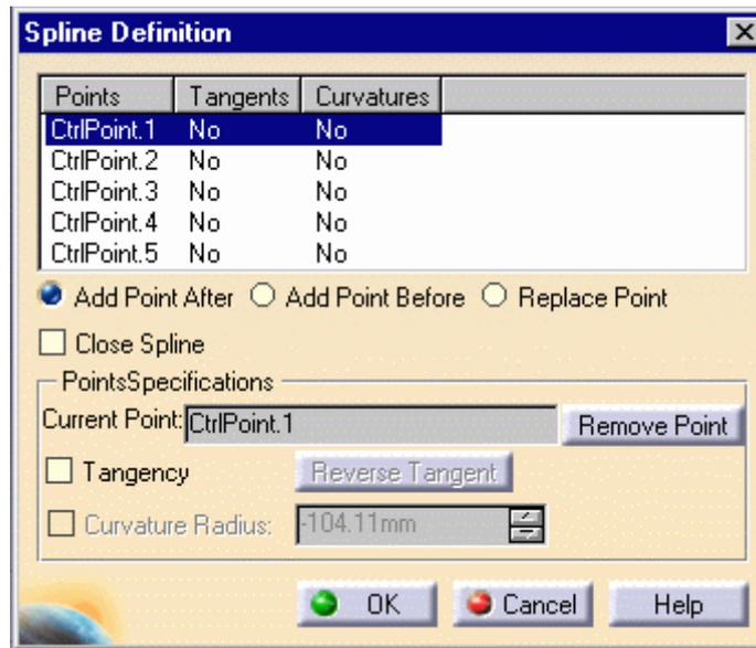
选中某控制点后可进行在当前点后增加点 (Add Point After)、在当前点前增加点(Add Point Before)、替换当前点(Replace Point)、删除当前点(Remove Point)和封闭样条曲线等操作。
