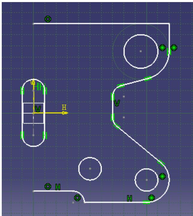
步骤四：使用 Auto Search，选择外轮廓，再按住Ctrl键选择两个圆，使用 对所选元素进行镜像复制。
