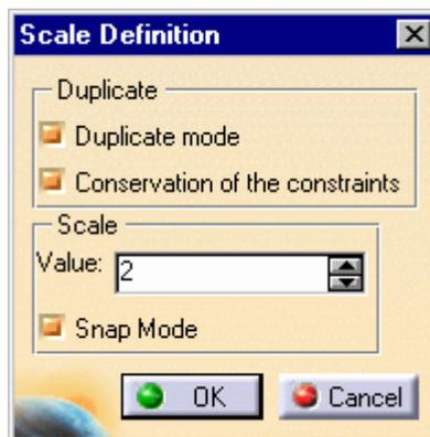
检查复制模式(Duplicate mode)状态，选中为复制， Instances(s)后可输入复制数目。不选中则为比例缩放。若选中保持约束(Conservation of the constraints)模式，则复制后元素保持原有约束。
