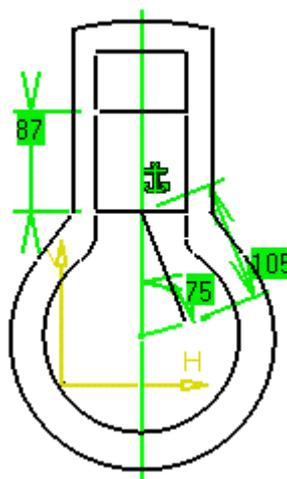
在初始值(First value)和最终值(Last value)里键入所希望的最大及最小值。在步距(Number of step)里输入初始值和最终值之间变化次数。点击
