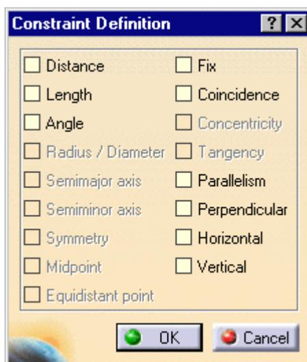
对话框可选部分因选择元素不同而呈现不同选项。选中所需约束，点击OK按钮。此对话框也可通过去除已选中的选项而解除已产生的约束。
