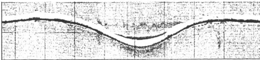
图 1 海管侧向屈曲的旁侧声纳扫描图
