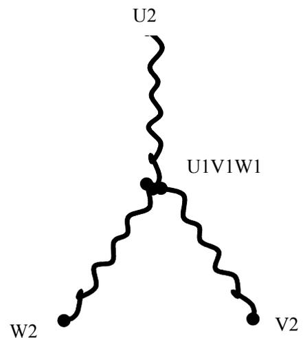
需要说明的是，AC380V，星形接法的电机，无疑要接在 380V 电源上。换成三角形接法就不能再接到 380V，而要接在 AC220V 电源上。这种电机设计时，每组线圈（U1U2、V1V2、W1W2）承受的电压为 AC220V，换句话说，也就是无论是三角或是星接，各组线圈必须承受 AC220V。否则，电机要么烧毁，要么出力不够。
