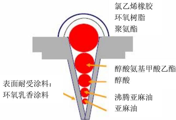
改性环氧涂料的表面耐受性降低了表面处理时间、停工时间和昂贵的喷砂处理成本。以一个轮船的压载舱为例，环氧乳香涂料（如 Balloxy HB Light）可以涂装在喷水清理的表面，整个施工可在轮船使用过程中进行。例如，VLCC 压载舱的整修维护可以节省 80 天的坞修时间。即使使用在各种方法处理后的表面，环氧乳香涂料的良好的表面耐受性和耐磨性保证了持久的涂料性能和长的使用寿命。
