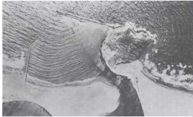
圖 23 波浪繞射至一個防波堤之狀況
