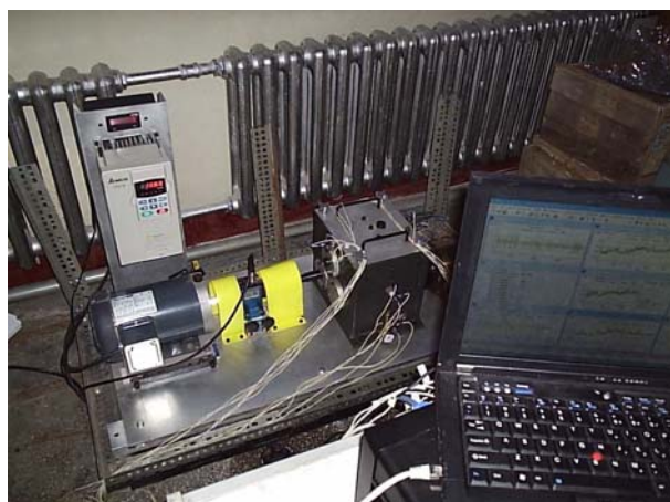
图 5.4 齿轮箱振动实验测试
