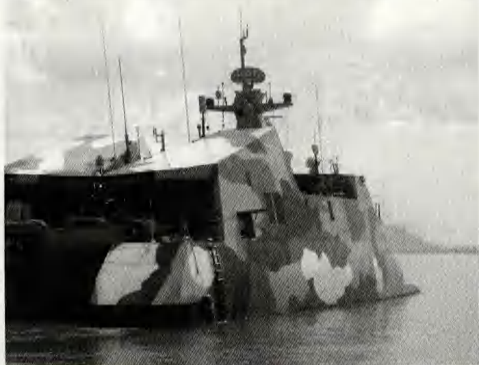
■ 022艇后视，图中可见三体消波滑行艇的尾板和双体船的复合特征十分明显
