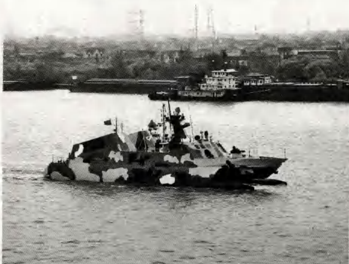
■ 022型导弹艇采用了三体消波滑行艇与穿浪双体船的复合设计
