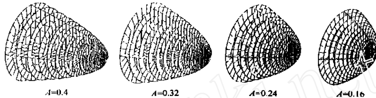
图 9 4 个球鼻艏内部结构有限元模型
