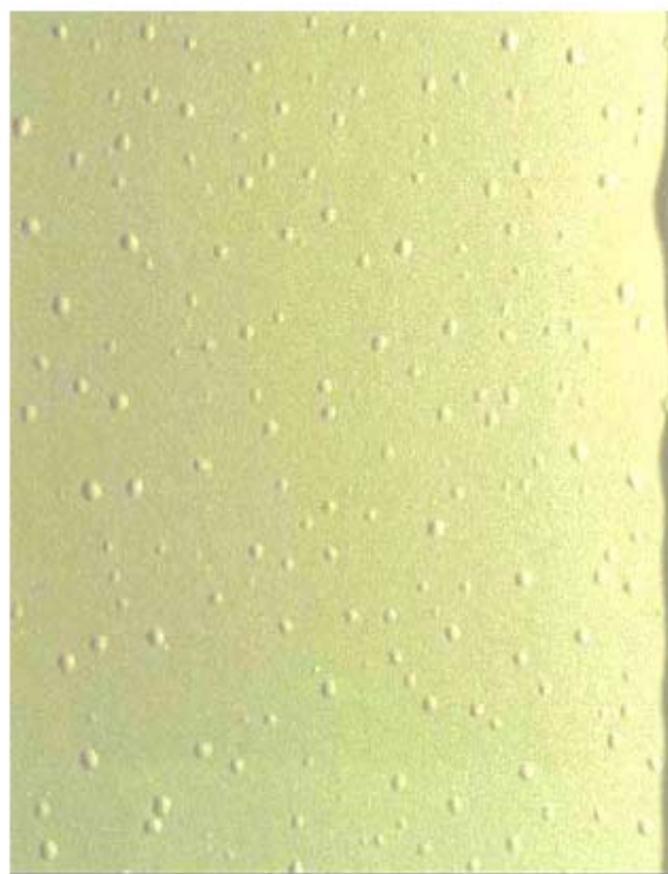
盐份浓度：200 毫克/平方米 150 微米干膜厚度
