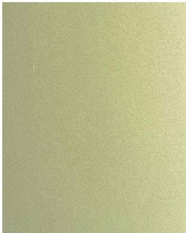
盐份浓度：0 毫克/平方米 150 微米干膜厚度
