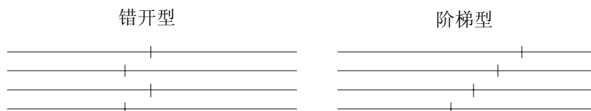
图 4 成束管子法兰的排列形状
