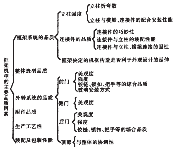
图 2 框架机柜的品质因素构成
