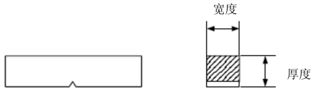
图4 夏比V型缺口试验试样
