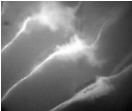
Fig. 5 Tip Vortex Cavitation
