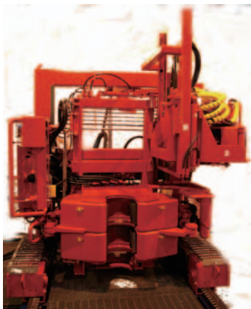
钻杆旋扣位置的轻型液压铁钻工
