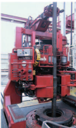
带对扣导向臂和宽轨的自动液 压铁钻工
