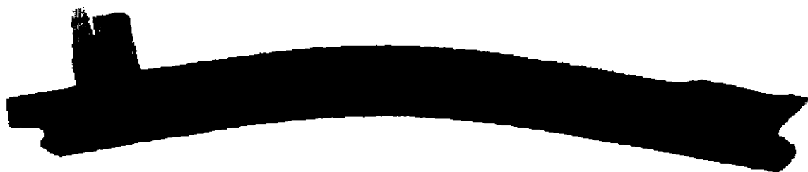
图 2 位移放大后的整船变形图
