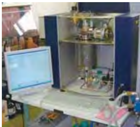
利用FIA-100FCA进行的燃烧试验 (燃烧试验标准 IP541/06)
