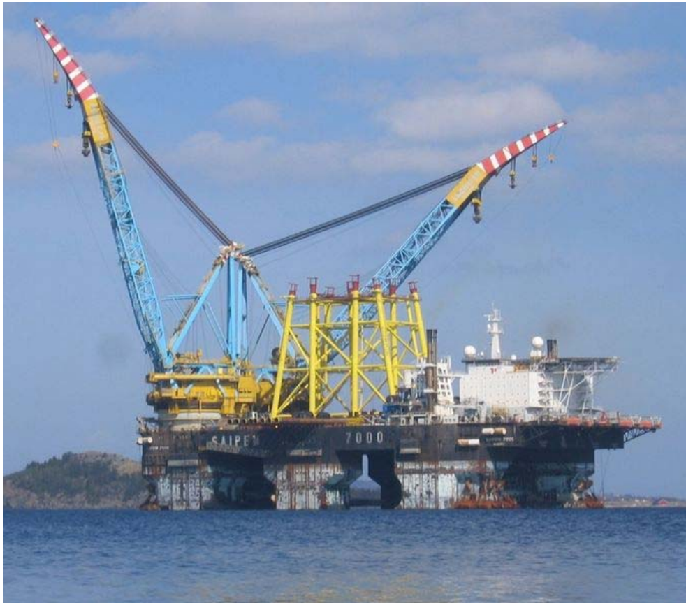
图 3 Saipem 7000 半潜式起重铺管船
