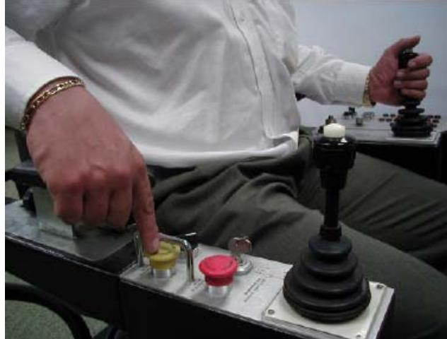
LIEBHERR 的应急钢丝绳释放系统设计已确保吊机操作员可以释放钢丝绳如吊钩被供应船抓住失控及供应船引起张力在钢丝绳上。在此情况，应急钢丝绳释放系统可以除了红色的紧急停机键外，按下“黄色紧急键”来启动。
