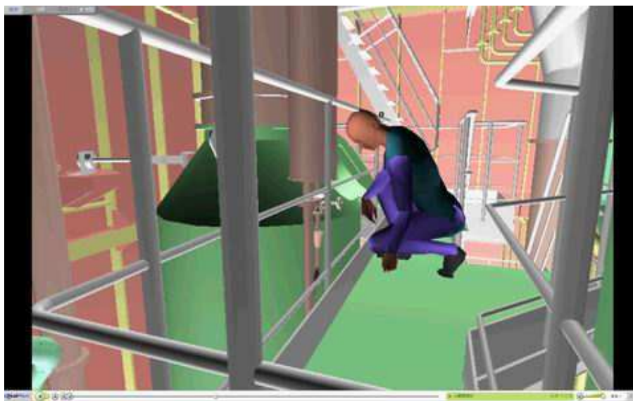
图 20: 图为模拟现场维修某一个阀门的情况
