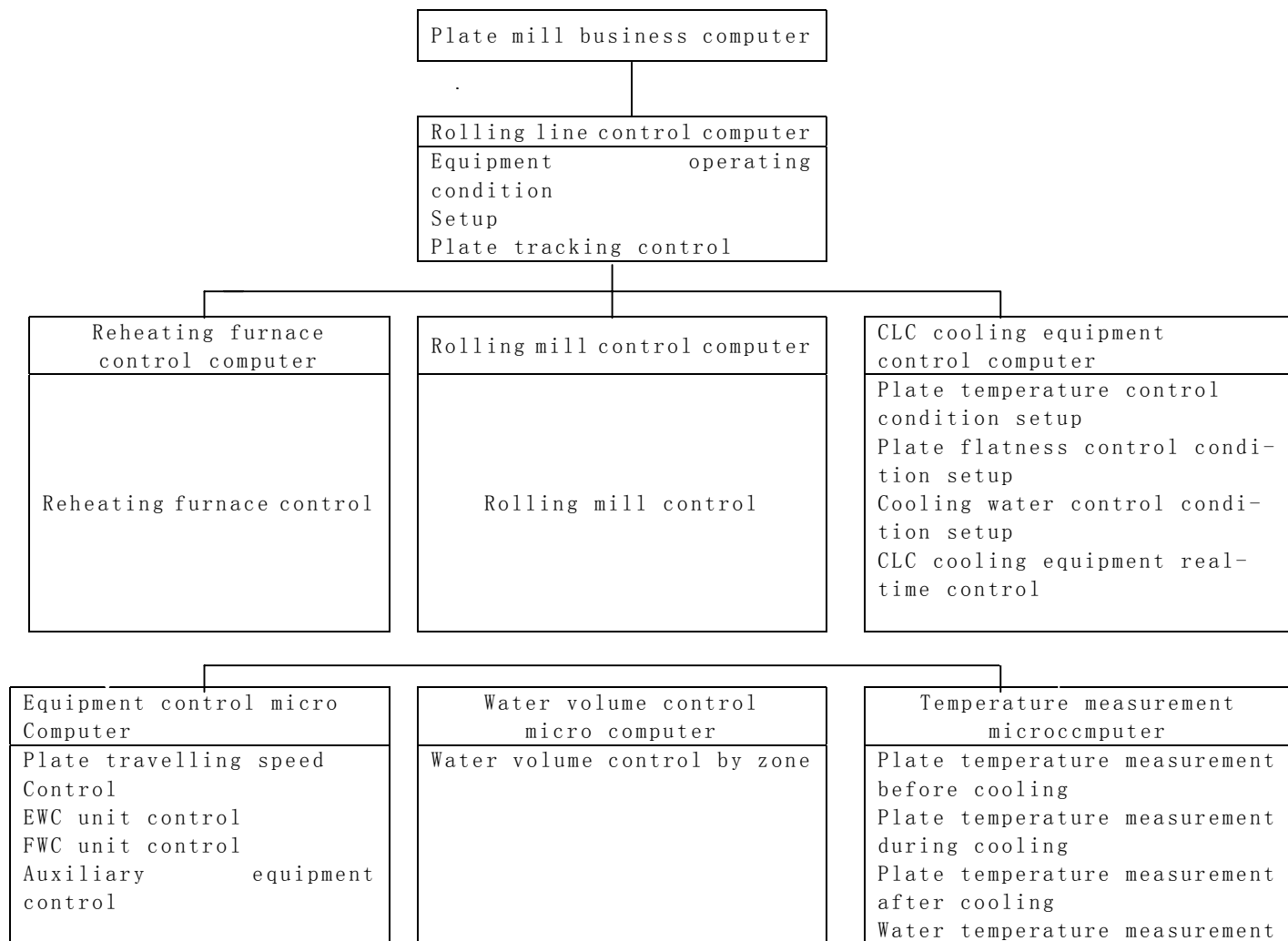
图 3 TMCP 工艺计算机控制系统匡图
