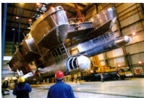
图 5.4 A&R 公司为德国近岸水域开发的小水线面双体引水船建造现场照片 Fig.5.4 Photo of hull of SWATH Pilot
