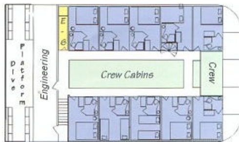
1-7c “PILOT”号小水线面双体船的全体人员舱室布置图
