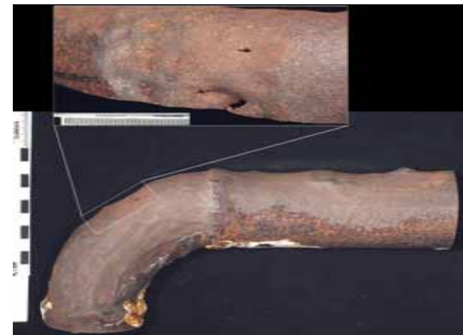
CO 2 corrosion in flowline 流体管道中的CO 2 腐蚀
