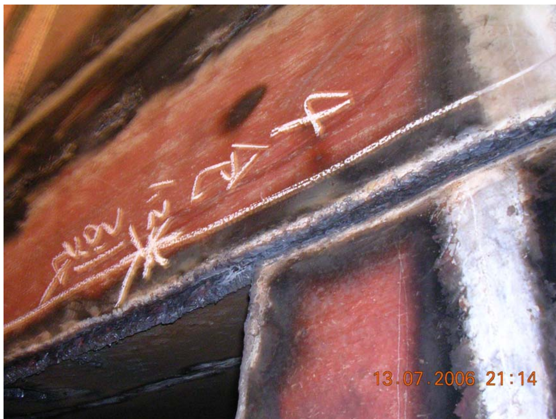
No. 4C. H. 横舱壁封板裂纹割开后
