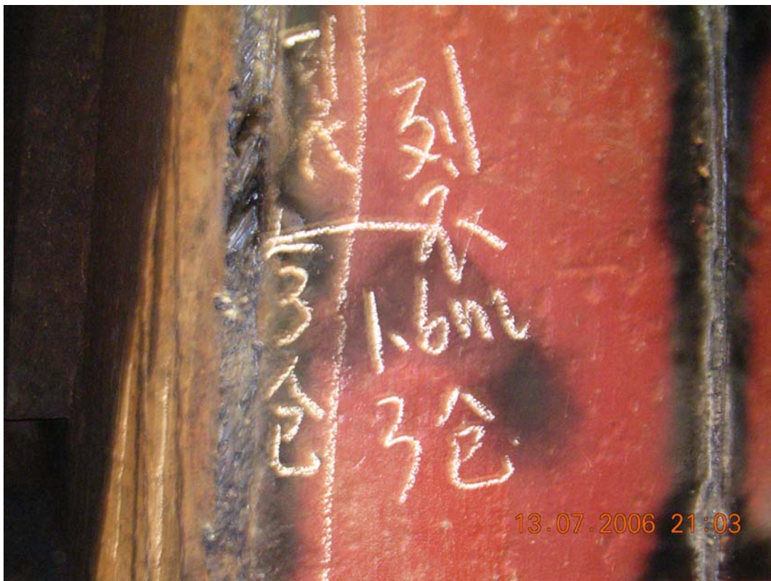
No. 3C. H. 横舱壁封板裂纹打开后
