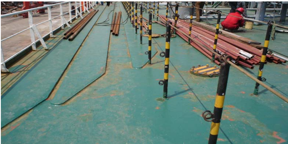
图示:甲板上的加强覆板条。与船底类似,因此照片比较清楚,用此来表示。
