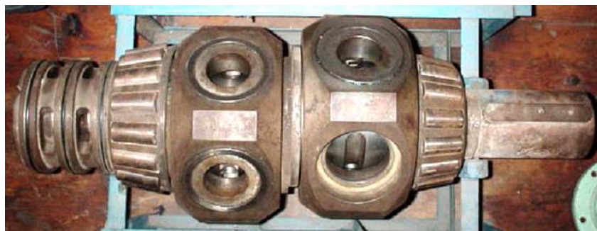
1-配流套 2-壳体 3-曲轴 4-五星轮 5-柱塞 6-定位套 7-内套 8-压力环 9-尼龙挡圈
