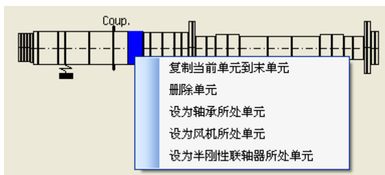
图 4.6 轴系布置图设置功能
