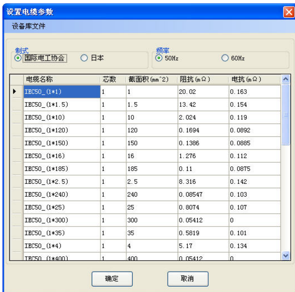
图 3.4.1.1 设置电缆参数
